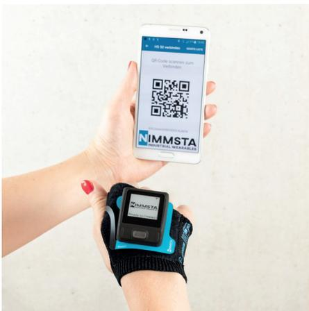
EASY CONNECT DURCH SCANNEN DES BARCODES AUF DEM ZIELGERÄT
